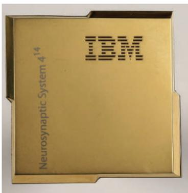
От традиционных процессоров, построенных на архитектуре фон Неймана, он отличается тем, что одно ядро чипа содержит сразу вычислительный и коммуникационный модули, а также собственную память. В результате все ядра процессора могут работать параллельно, обрабатывая за единицу времени очень большие объёмы данных, а мощность всей вычислительной системы очень легко наращивать, просто соединяя несколько чипов.
