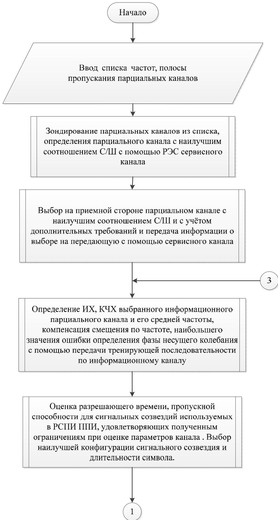
Рис. 5.11 а. Алгоритм функционирования фазовой РСПИ ППИ, реализующей алгоритмы обработки сигналов на базе теории разрешающего времени
