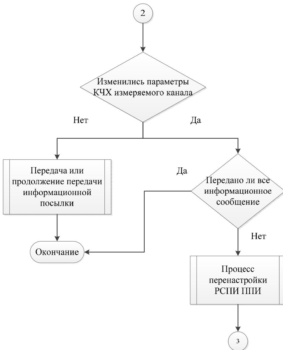
Рис. 5.11 в. Алгоритм функционирования фазовой РСПИ ППИ, реализующей теорию разрешающего времени
