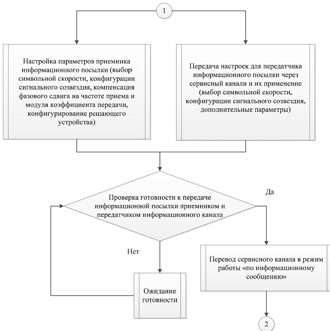
Рис. 5.11 б. Алгоритм функционирования фазовой РСПИ ППИ, реализующей теорию разрешающего времени
