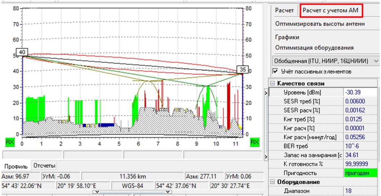
Рисунок 4.2 – Визуализация результата расчёта на профиле интервала
