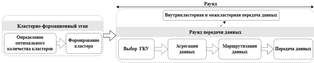
Рисунок 2 – Диаграмма этапов работы алгоритма маршрутизации KmHNNSP в течение одного раунда передачи данных
